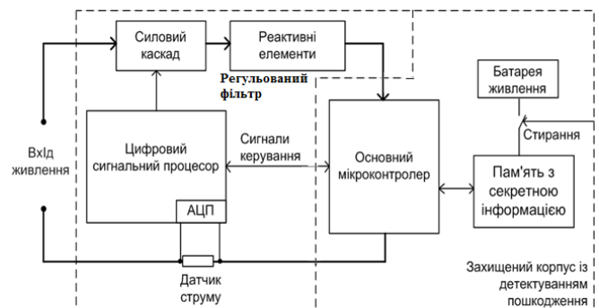
Рис. 6. Схема регульованого фільтра живлення мікроконтролера з вимірюванням струму у реальному масштабі часу
