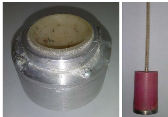
Рис. 6. Радіометр поплавкового типу: а – схема експериментальної установки; б – лабораторний макет сфокусованої ультразвукової системи; в – лабораторний макет радіометру.
