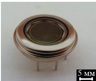
Рис. 1 Кремнієвий 4-елементний p - i - n фотодіод
