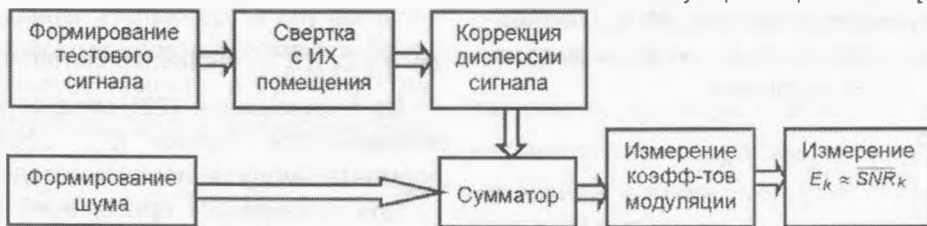
Рис. 1. Процедура измерений эквивалентных отношений сигнал-шум
