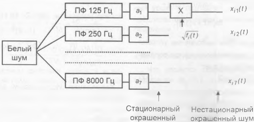
Рис. 2. Схема формирования компонентов тестового сигнала
