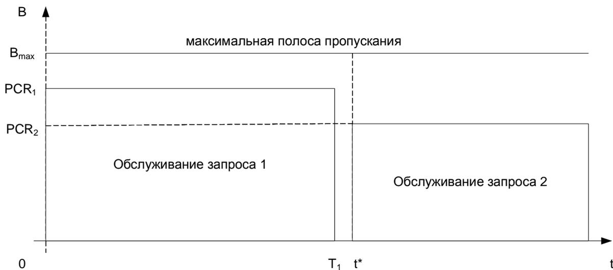
Рис.2. Пример работы модифицированного алгоритма
