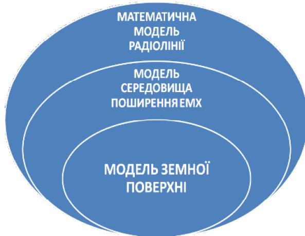
Рис. 1. Принцип формування математичної моделі радіолінії
