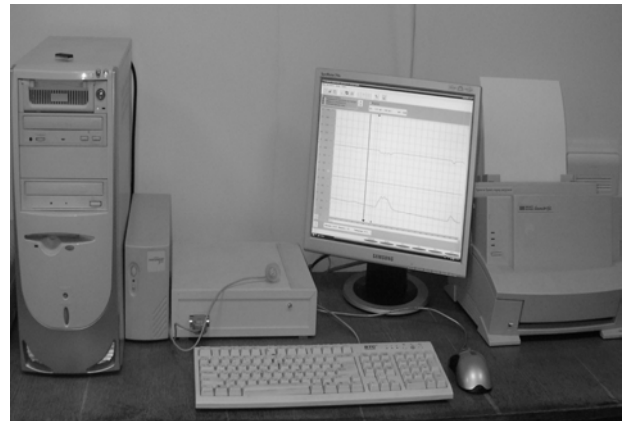
Рис. 5. Вимірювальний канал для дослідження газообмінних процесів
