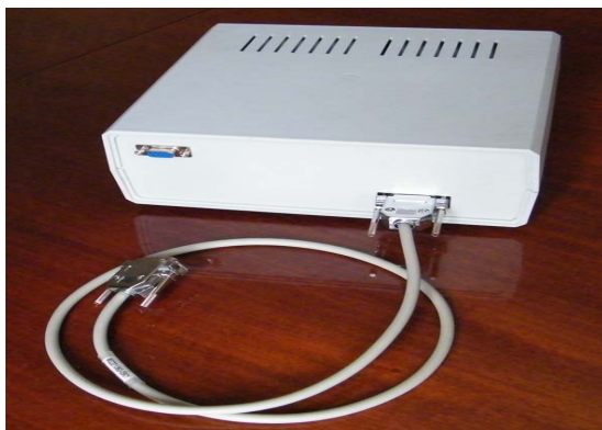
Рис. 4. Зовнішній вигляд універсального ЕКГ симулятора та основна плата симулятора
