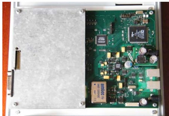
Рис. 4. Зовнішній вигляд універсального ЕКГ симулятора та основна плата симулятора
