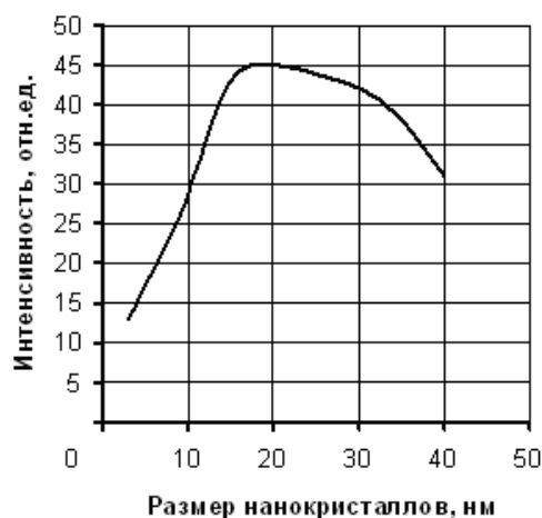
Рис. 3. Зависимость интенсивности фотолюминесценции пленок нанопористого кремния от размеров нанокристаллов на длине волны 650 нм
