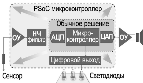
Рис. 7. Обычное схемное решение и вариант с PSoC микроконтроллером для схемы управления выходными приборами по сигналу сенсора (светодиоды и звуковой сигнал)
